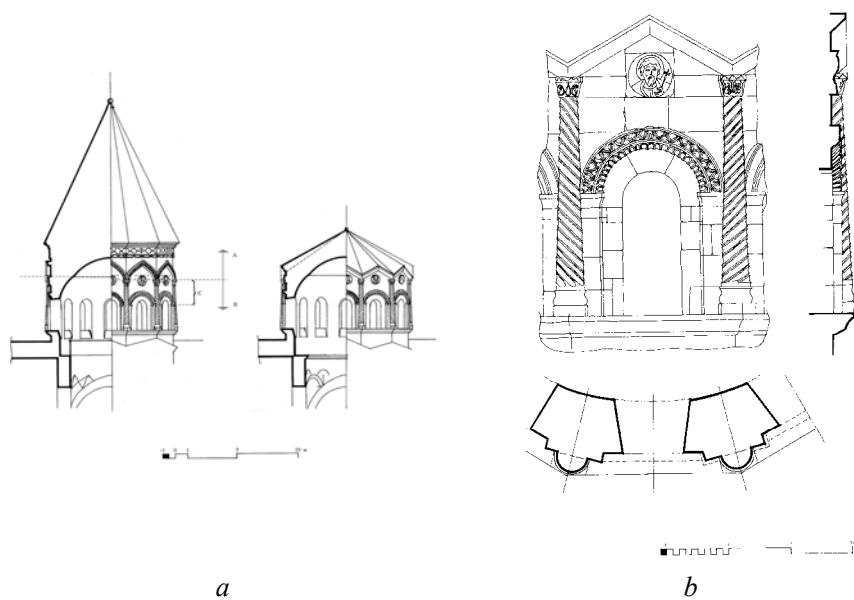
3. Собор Эчмиадзин: a — нынешний вид и реконструкция купольной главы VII в.; b — грань барабана VII в.
